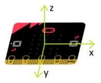
C'est cette puce qui permet au micro:bit de calculer les mouvements de celui-ci comme lorsqu'on le secoue ou le retourne. On peut donc utiliser cet outil pour faire une alarme qui alertera l'utilisateur si quelqu'un bouge un objet sans accord par exemple.
